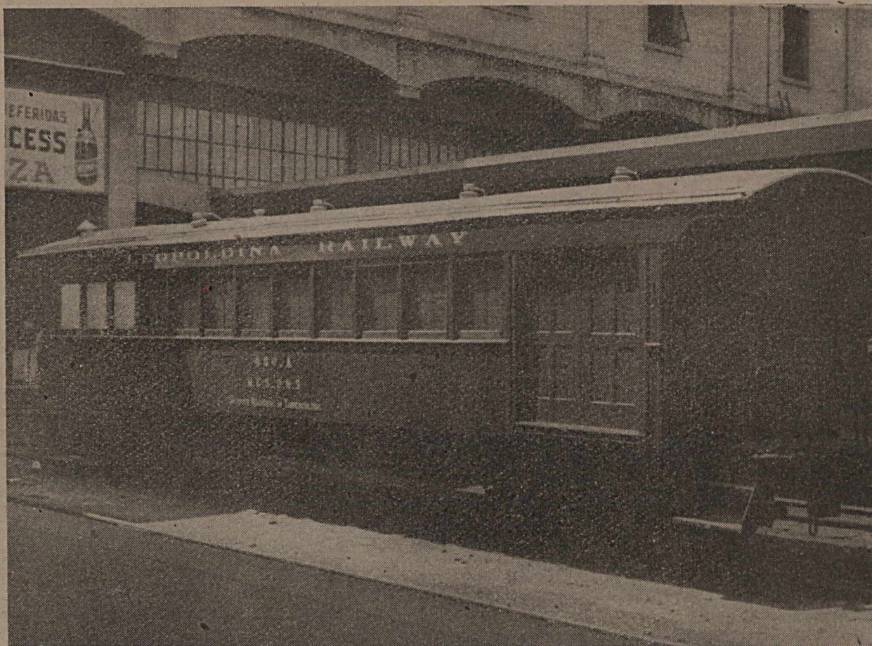
S.N.T. — Vagão da Leopoldina Railway adaptado pelo S.N.T. para núcleo móvel de cadastro torácico e inquérito tuberculínico, dispondo de um aparelho Manoel de Abreu, de um grupo eletrogênico e material completo à sua finalidade. Atualmente está em serviço junto às usinas de açúcar de Campos
