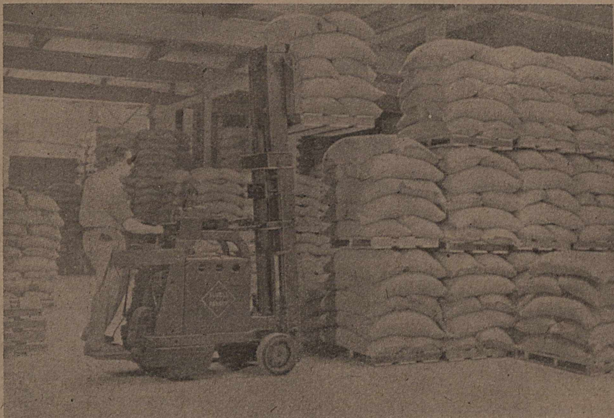
A figura, muito significativa, apresenta um truck-elevador empilhando uma sacaria. Como se pode notar, um homem, apenas, pode movimentar todo o material dum depósito, graças ao efficientíssimo trabalho deste tipo de carro.
