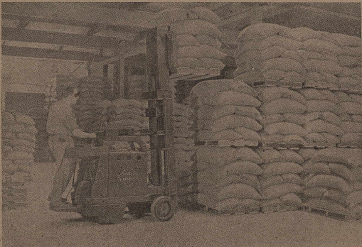
A figura, muito significativa, apresenta um truck-elevador empilhando uma sacaria. Como se pode notar, um homem, apenas, pode movimentar todo o material dum depósito, graças ao eficientíssimo trabalho deste tipo de carro.
