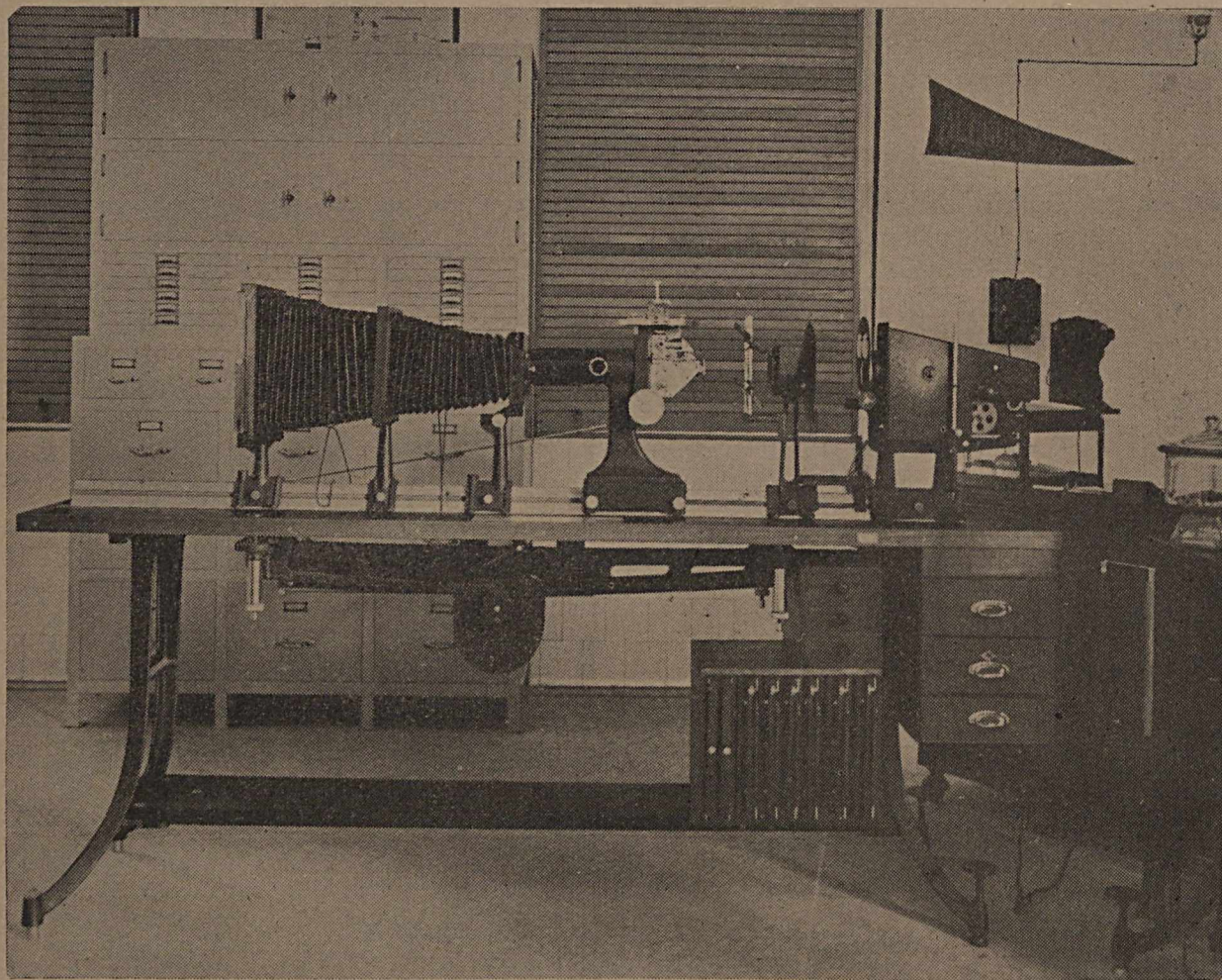
Microscópio metalográfico. É o principal auxiliar do metalurgista no laboratório, permitindo-lhe inúmeras conclusões seguras, impossíveis de obter por outros meios
